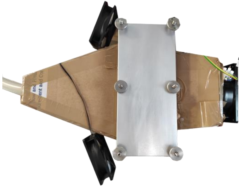
Obrázek 28 Svazek palivových článků z vrchního pohledu s přívodem vzduchu z radiálního kompresoru přes kartonový nástavec (1), bočními ventilátory pro chlazení (2) a zadním ventilátorem pro odtažení vzduchu z prostoru výstupu vzduchu (3)
