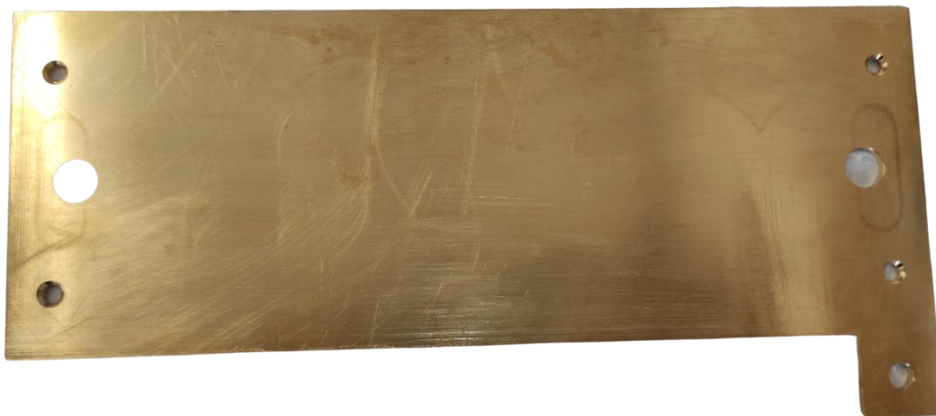
Obrázek 21 Kolektor proudu s povrchovou úpravou
