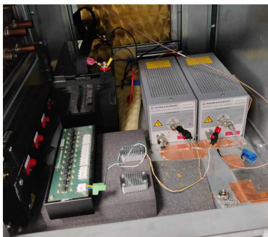
Obrázek 4.1 Měřicí stanoviště pro měření CISPR25 s modulem NCV78514
