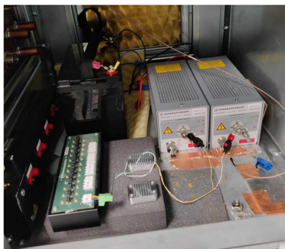
Obrázek 4.1 Měřicí stanoviště pro měření CISPR25 s modulem NCV78514
