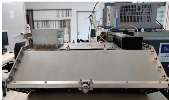
Obrázek 4.9 Měřicí stanoviště pro měření metody TEM komory s modulem NCV78514 z bočního pohledu
