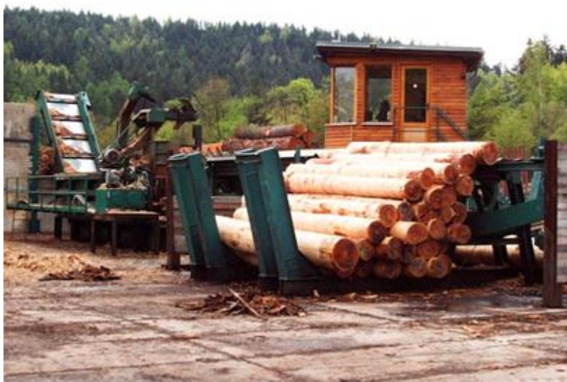
Obrázek 12 Frézovací odkorňovač s reduktorem kořenových náběhů
