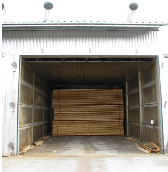
Obrázek 15 Postup plnění Komorové sušárny
