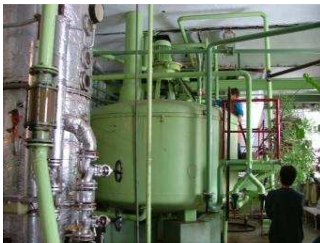
Obr. 4 Zcukřování zápary – zapařovací kád' [11]
