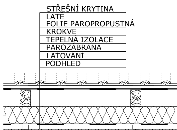
Obr. 10 Obecná skladba podkroevní tepelné izolace [57, 58]
