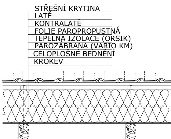
Obr. 9 Skladba nadkrokevního systému ISOVER [57]
