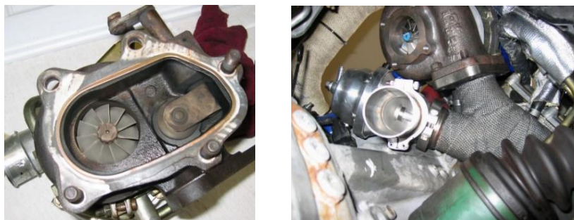
Obr. 29: Interní (vlevo) a externí (vpravo) konstrukce obtokového ventilu turbíny [18]
