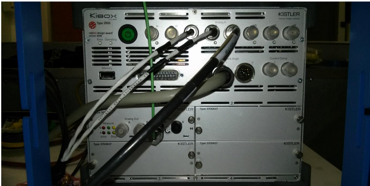
Obr. 85: Jednotka zesilovače pro indikaci spalovacího tlaku KiBox 2893A
