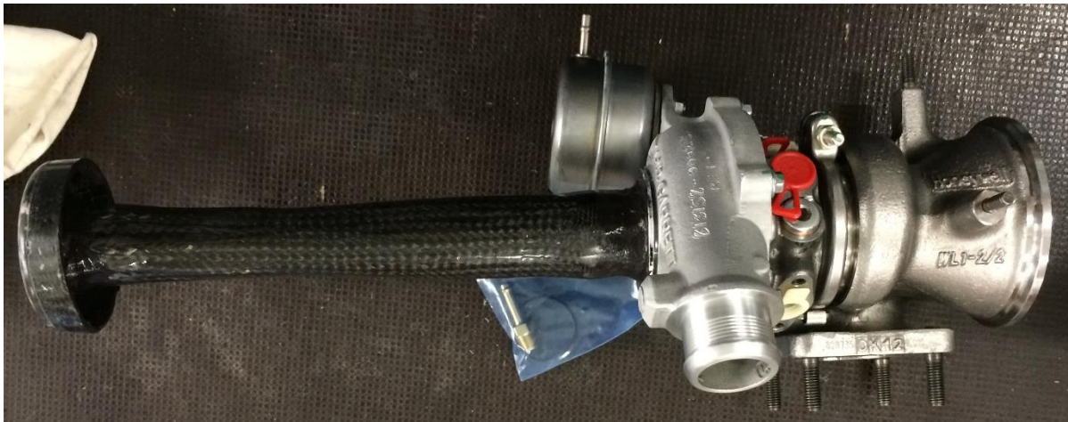
Obr. 57: Turbodmychadlo NGT1341 s restriktorem nasávaného vzduchu
