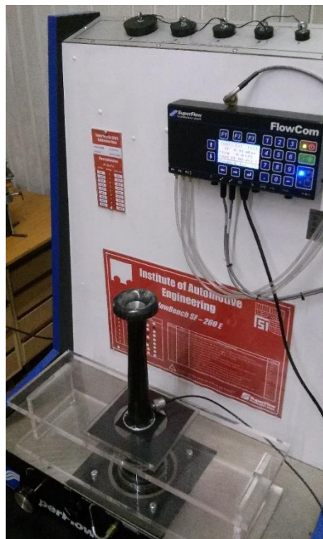
Obr. 74: Měření na profukovačce Superflow Flowbench SF-260E
