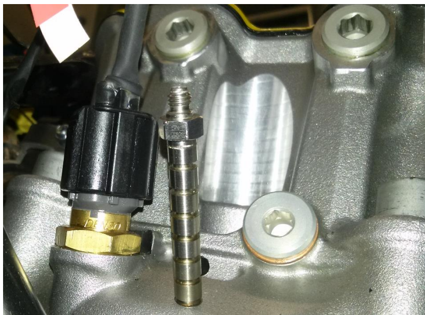
Obr. 84: Umístění vysokotlakého snímače spalovacího tlaku v hlavě válce motoru
