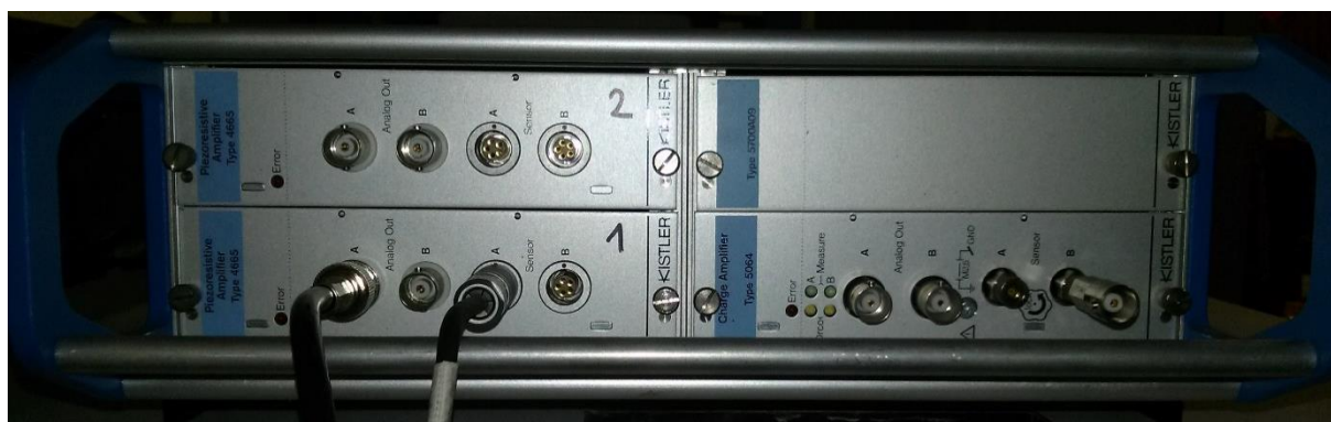
Obr. 88: Jednotka zesilovače signálu Kistler typ 2854A132
