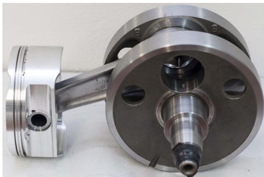
Obr. 50: Klikový mechanismus turbodmychadlem přeplňovaného motoru Husqvarna FE 501
