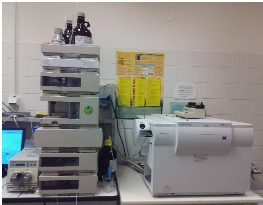
Obrázek 22: Kapalinový chromatograf (Agilent 1100 Series) s hmotnostním spektrometrem (Agilent 6320 Series), Ion Trap LC/MS (Agilent Technologies, USA)
