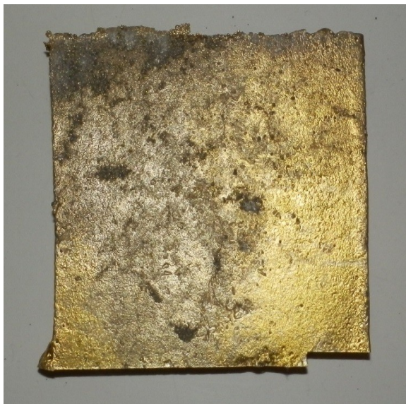
Obr. 19 Odlitá destička ze slitiny CuZn 30
