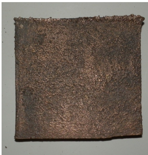
Obr. 20: Odlitá destička z elektrovodné mědi
