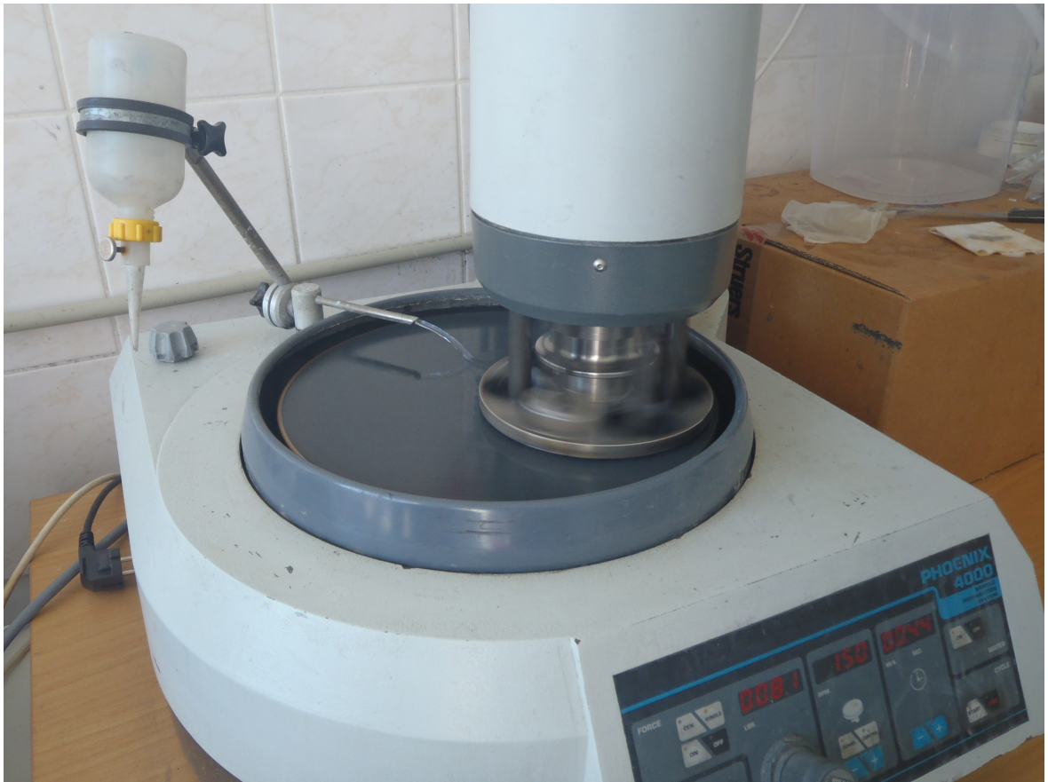
Obr. 24 Broušící zařízení během broušení
