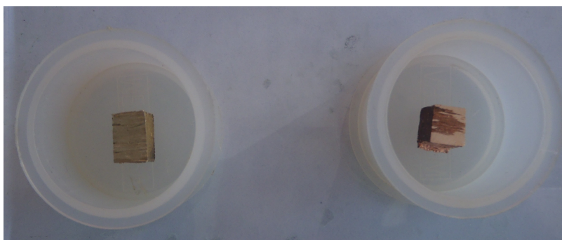
Obr. 22: Vzorky připravené na zalití Dentakrylem. Vlevo vzorek A vpravo vzorek B
