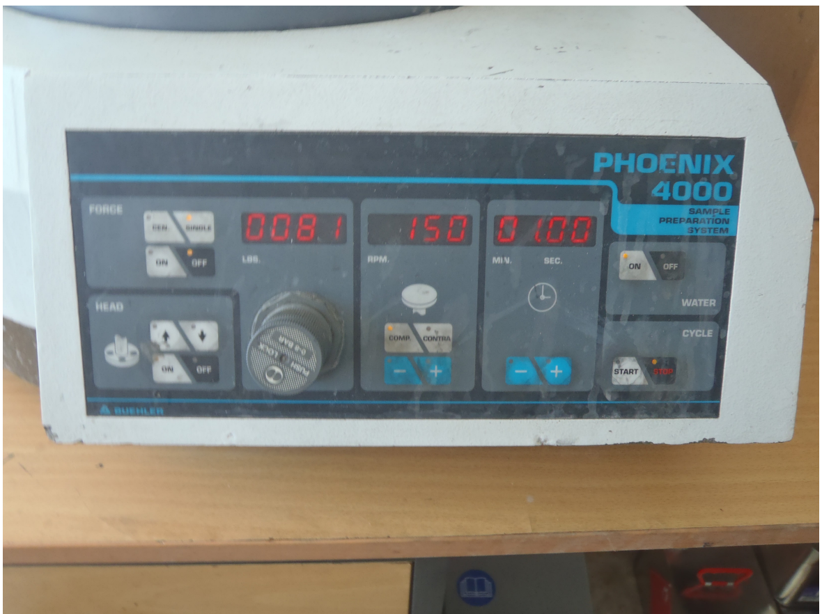
Obr. 25: Nastavené parametry broušícího zařízení
