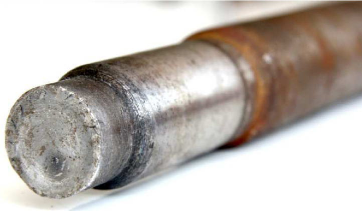
Obr. č. 23 – Poškozená přední hnací hřídel vozidla MAGMA Alficar, detail lomu
