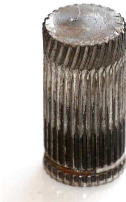
Obr. č. 22 – Poškozená přední hnací hřídel vozidla MAGMA Alficar, detail
