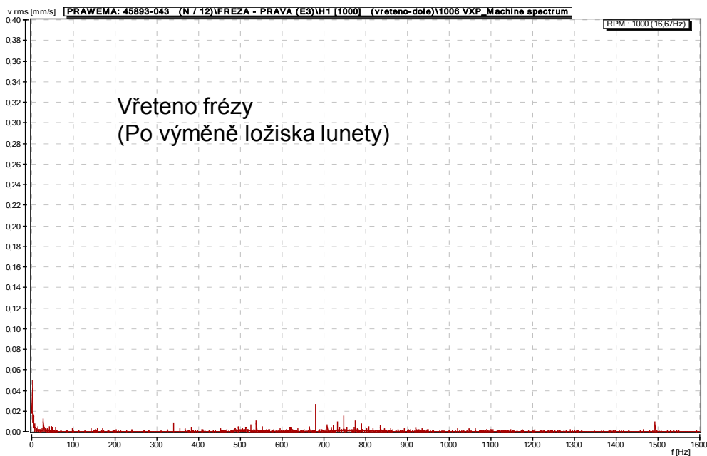
Příloha č. 3 Spektra rychlosti vibrací pro vřeteno a lunetu frézy načisto E3
