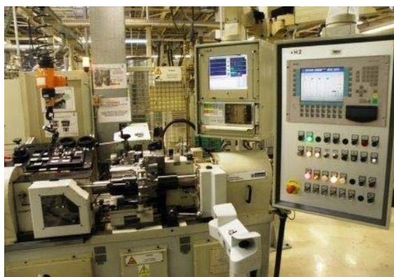
Obr. 4 Zkušební stanice převodovek se snímači
