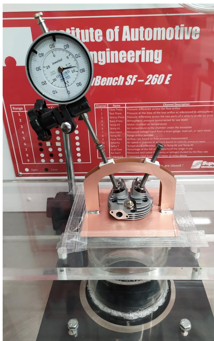
Obr. 37 Přípravek na profukovací stanici
