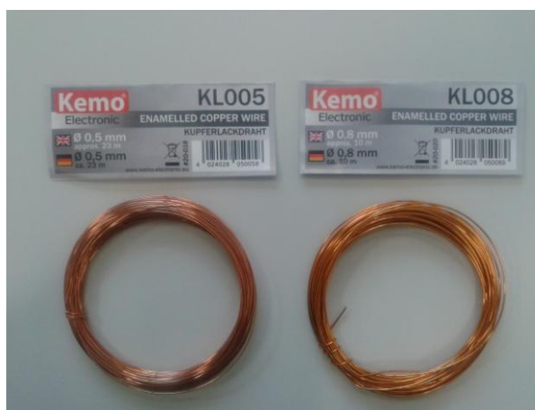
Obrázek 9: Použité dráty o průměru 0,5 mm a 0,8 mm
