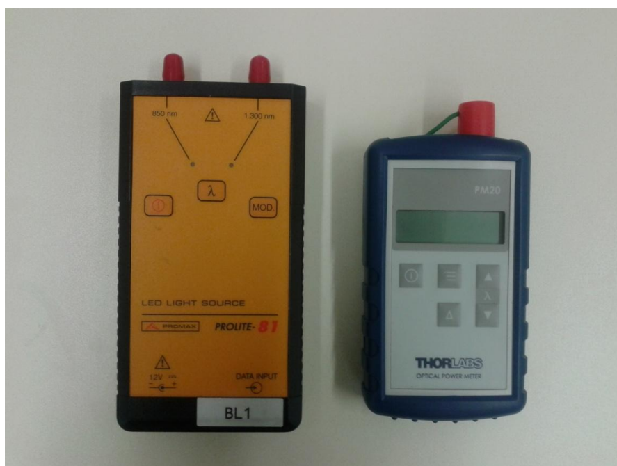
Obrázek 11: a) Zdroj PROLITE 81(850-1300nm), b) Detektor PM20
