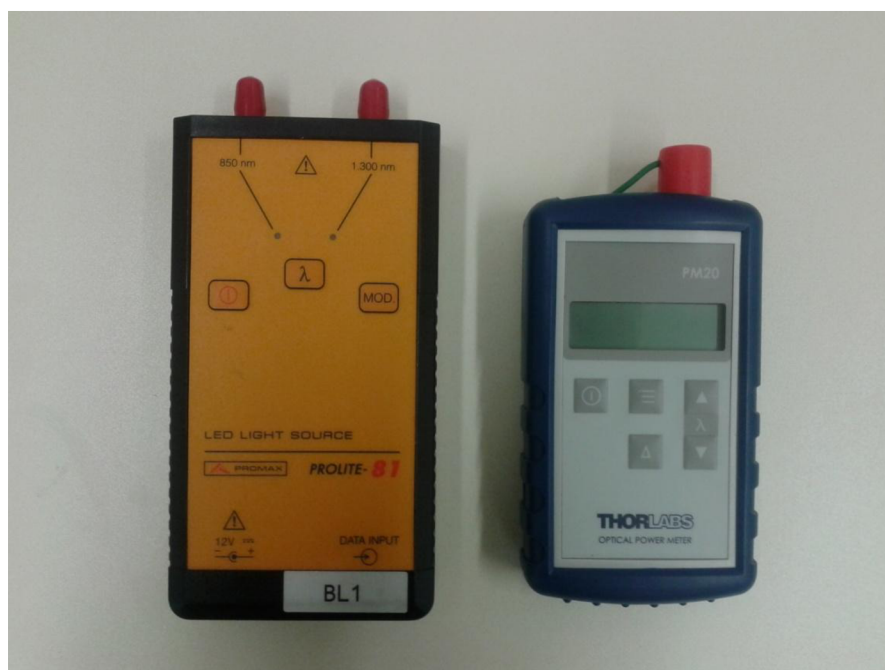
Obrázek 11: a) Zdroj PROLITE 81(850-1300nm), b) Detektor PM20
