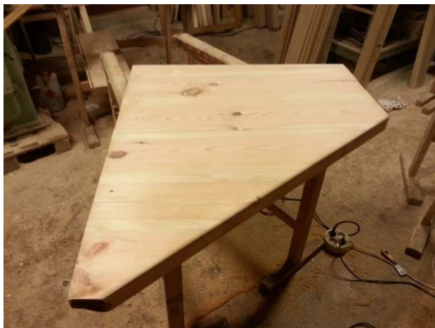
Obr. 2 Broušení a vyspravení stupnic schodiště
