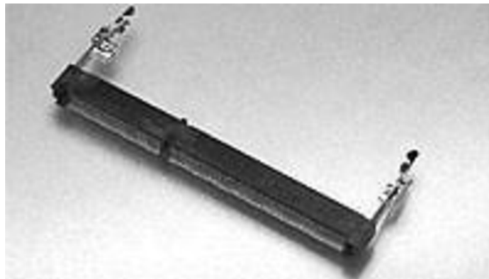
Obr.č. 13 SODIMM konektor pro povrchovou montáž [11]
