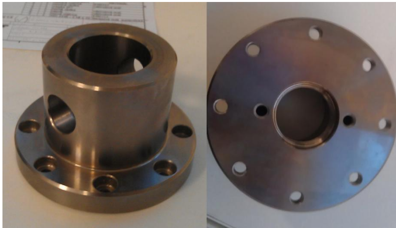
Obr. 34 Upínací prípravok skúšobného stroja
