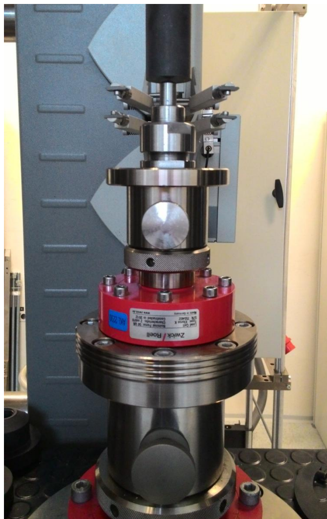
Obr. 33 Univerzálny skúšobný stroj Zwick Z250 v konfigurácii s navrhnutým skúšobným prípravkom pre penetračné skúšky
