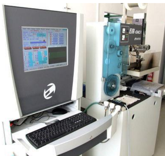
Obr. 4 Programovateľné zariadenie na princípe elektroiskrového rezania [9]
