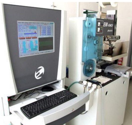
Obr. 4 Programovateľné zariadenie na princípe elektroiskrového rezania [9]
