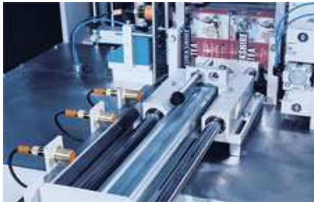
Obr. 13) Příklad použití indukčních snímačů [15]
