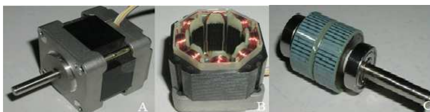
Obr. 12) a) Krokový motor, b) Stator, c) Rotor [14]
