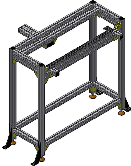
Obr. 34) Stojan navíječky kompozitního izolátoru
