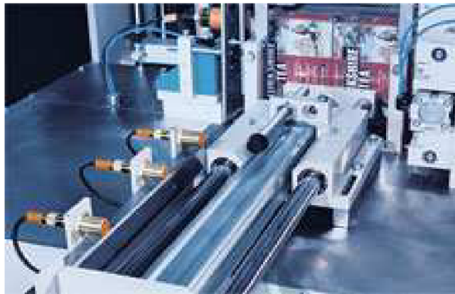
Obr. 13) Příklad použití indukčních snímačů [15]
