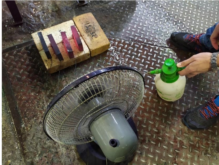
Obr. 3.8 Chladenie ventilátorom a striekanie vody do prúdu vzduchu
