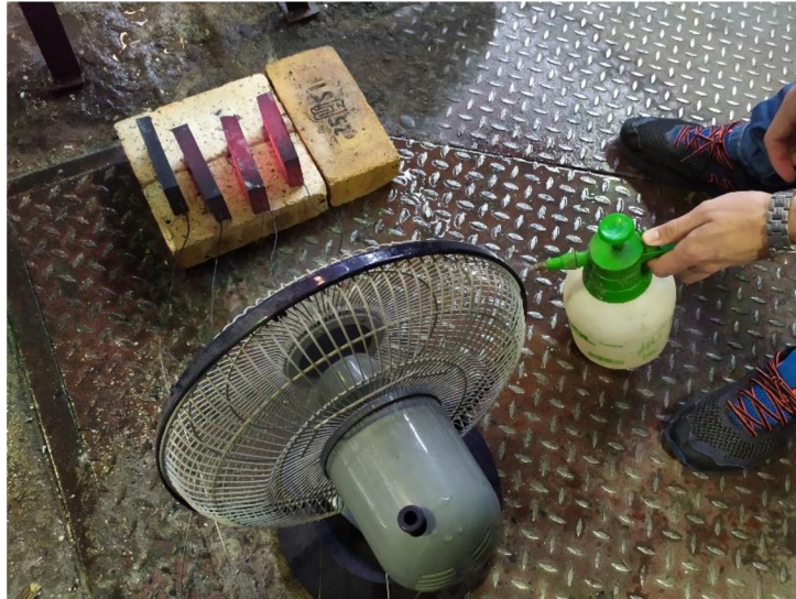
Obr. 3.8 Chladienie ventilátorom a striekanie vody do prúdu vzduchu
