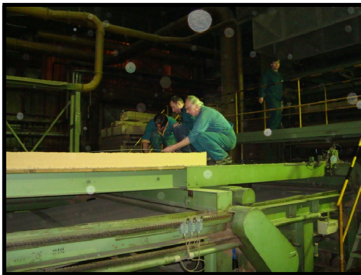
Obrázek 4-6: Zaměstnanci DLL při vkládání čidla do středu dřevovláknitého koberce.
