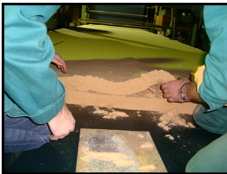
Obrázek 4-7: Ukázka vložení čidel do středu vláknitého koberce.
