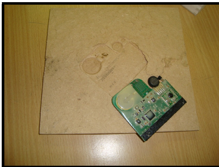
Obrázek 4-8: Vyjmutí čidla z desky.
