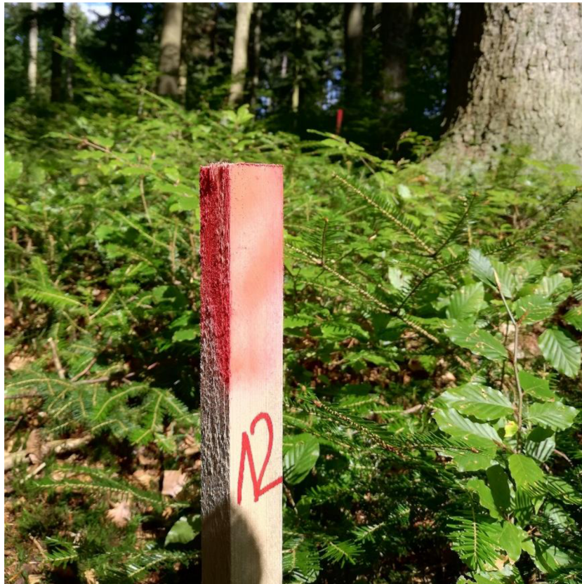
Obrázek 5: Reflexně označený vytyčovací kolík s pořadovým číslem plochy (foto: T. Vydra, Kostelec nad Černými lesy, 2021)
