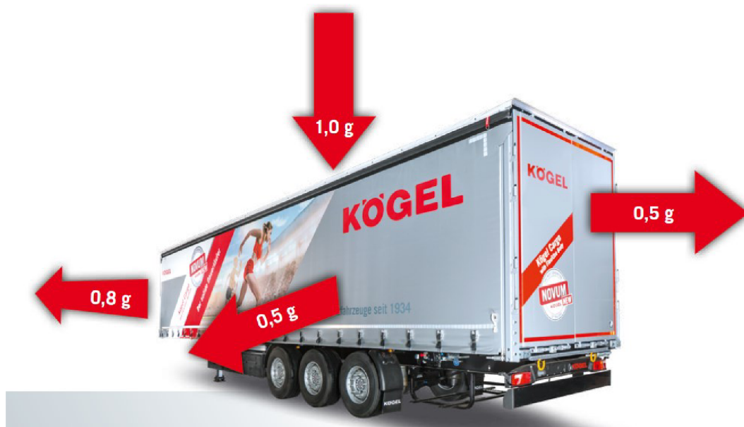
Obr. 3.5 Síly působící na náklad během jízdy
