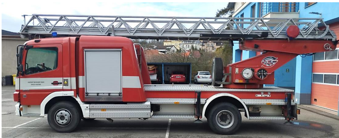
Obrázek 7: Automobilový žebřík AZ 30-M1Z MB Atego
