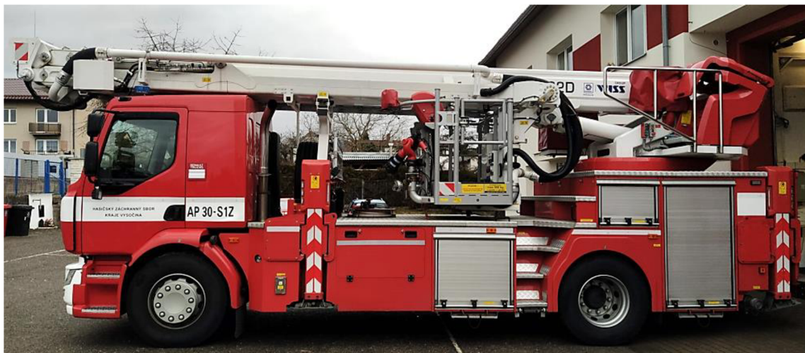
Obrázek 6: Automobilová plošina AP 32-S1Z BUMAR Renault
