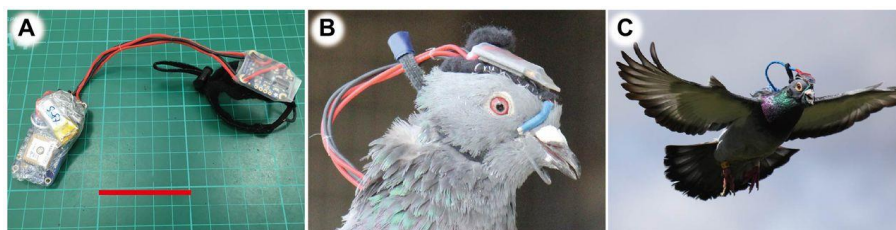
Obrázek 2- vybavení holuba. (A) GPS záznamník, mikropočítač, micro-SD karta a baterie (vlevo; k nošení v batohu) připojené k inerciální měřicí jednotce (IMU) namontované na masce na míru (vpravo; k nošení na hlavě). (B, C) Holub v masce a záznamník.
