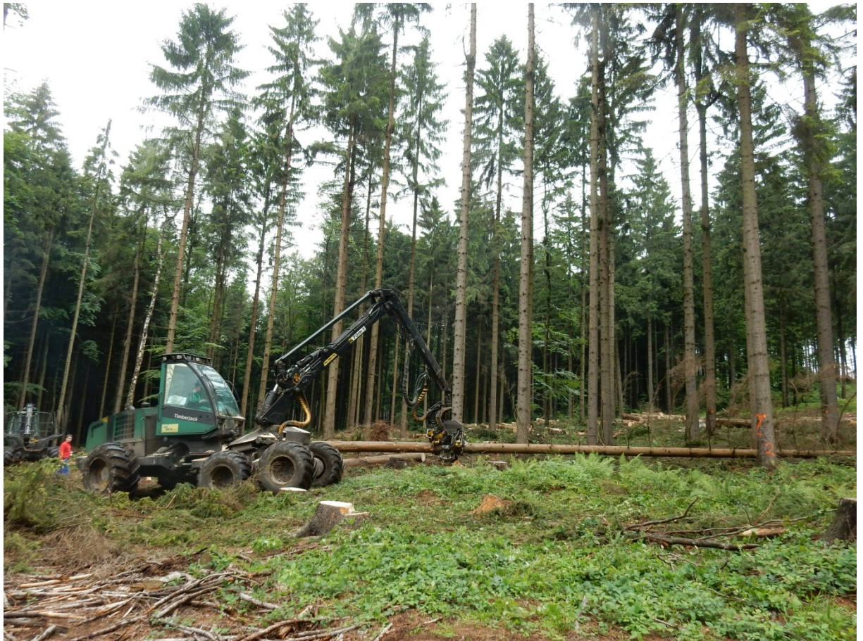
Obr. 7 Zpracování stromu harvestorem (Zemánek, vlastní foto 2016)
