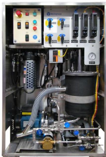
Obr. 4-1: Vylepšený systém TELESCOPE Sipping pro AP1000 [27]
