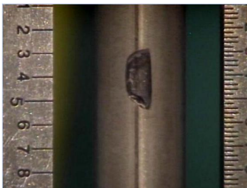
Obr. 2-1: Příklad otěru proutku o distanční mřížku (grid to rod fretting) [4]
