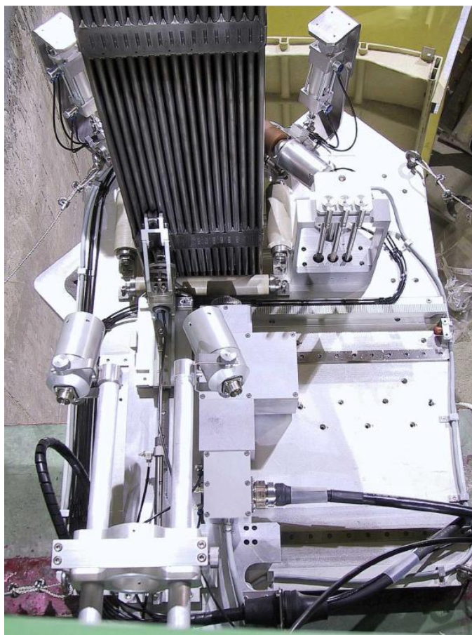
Obr. 4-21: Zařízení pro měření tloušťky oxidické vrstvy periferních proutků SICOM-COR [43]
