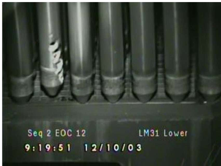
Obr. 2-2: Poškození palivového proutku cizím předmětem [8]
