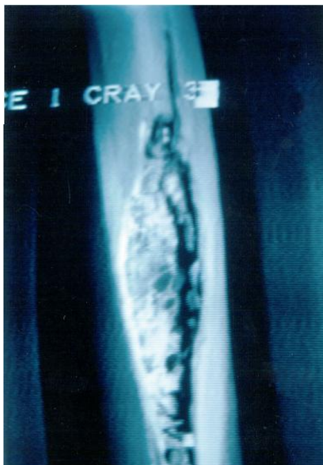
Obr. 2-11: Poškození pokrytí hydridací [18]
