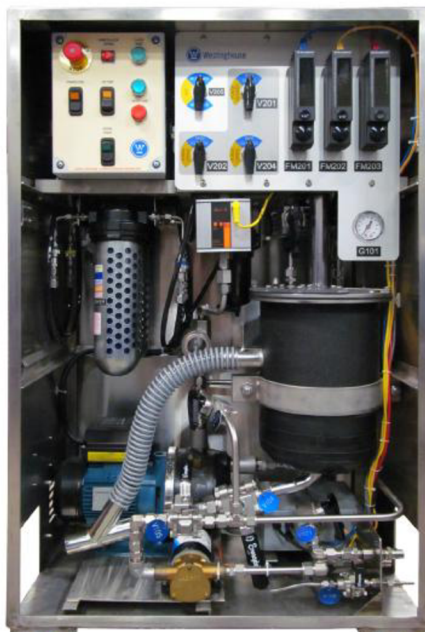
Obr. 4-1: Vylepšený systém TELESCOPE Sipping pro AP1000 [27]
