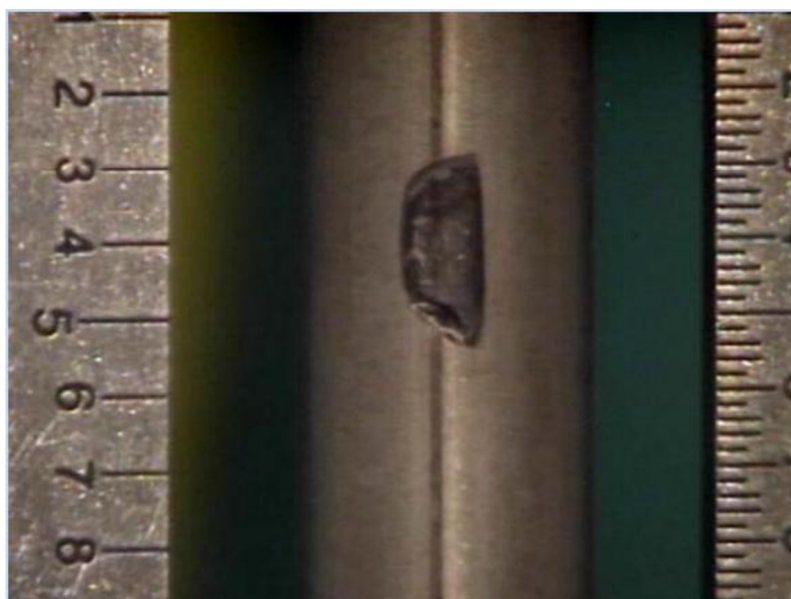
Obr. 2-1: Příklad otěru proutku o distanční mřížku (grid to rod fretting) [4]
