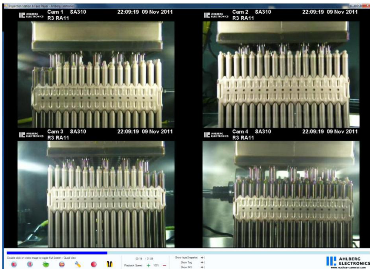
Obr. 4-13: 4-Face inspekční systém [38]
