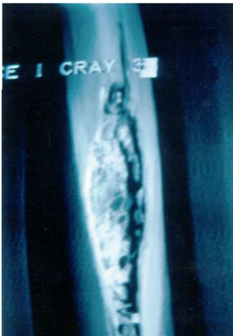
Obr. 2-11: Poškození pokrytí hydridací [18]
