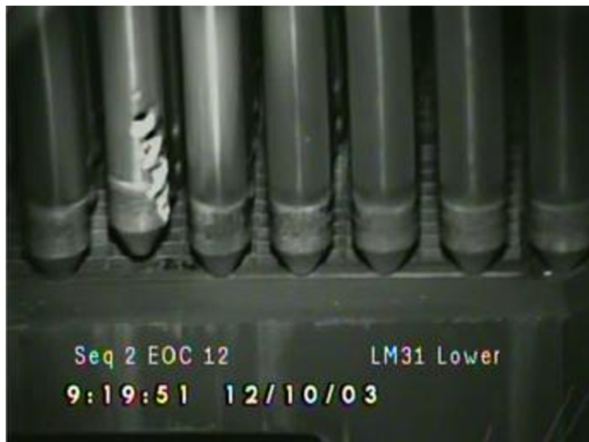
Obr. 2-2: Poškození palivového proutku cizím předmětem [8]
