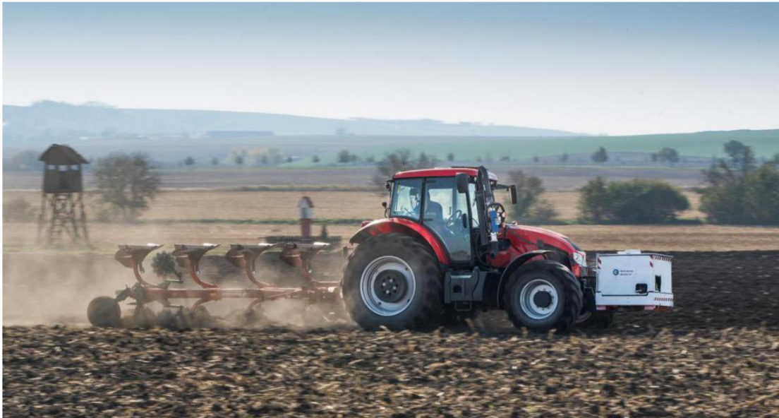
Obrázek 6 Měření emisí traktoru za provozu [archiv TÜV SÜD]
