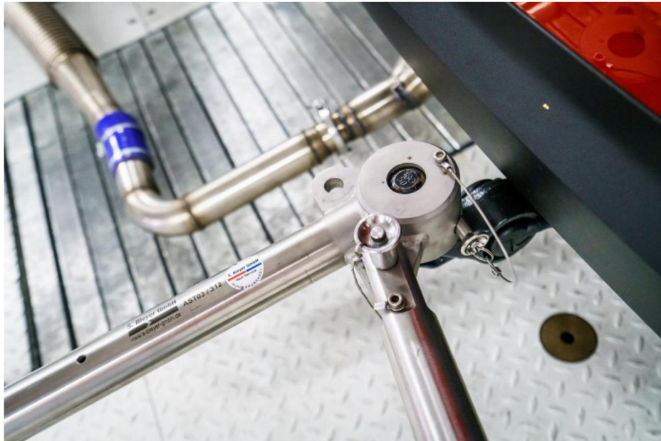
Obrázek 10: Ukotvení vozidla a připojení výfukového potrubí [archiv TÜV SÜD]
