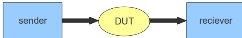
Obrázek 3.2: Topologie s odděleným přijmačem a vysílačem pro testování
