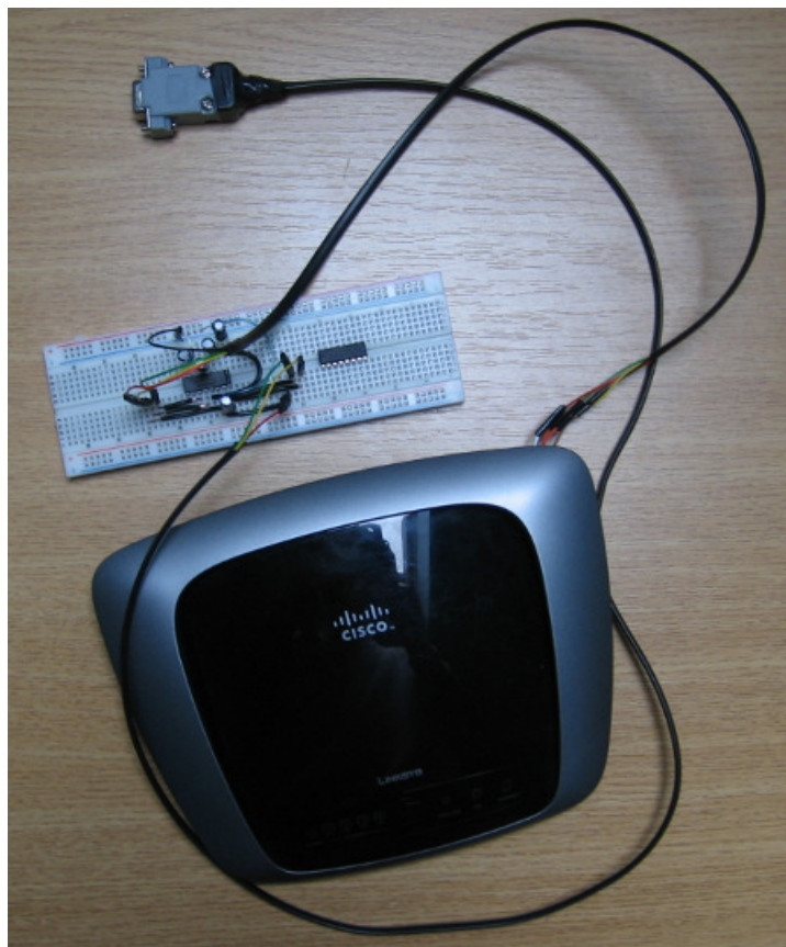
Obrázek 5.3: Router se sériovým TTL převodníkem
