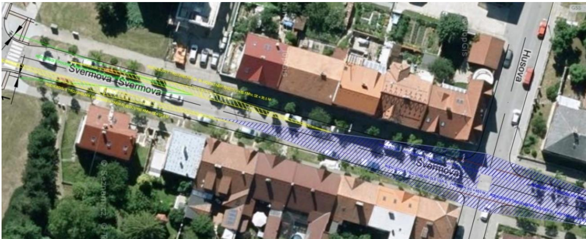
Obr. 118: Stávající stav s rozhledovými poměry na ulici Švermova
