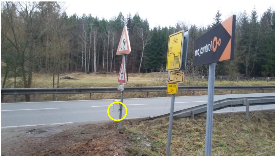
Obr. 20: Radar na lokalitě 3 byl umístěn na silnici II/150 na dopravní značce A 8 Nebezpečí smyku a A 24 Náledí s dodatkovou tabulkou E 4 Délka úseku
