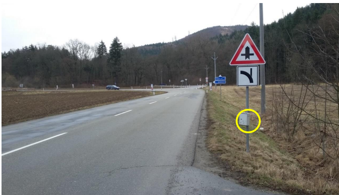
Obr. 19: Radar na lokalitě 2 byl umístěn na silnici II/374 na dopravní značce P 1 Křižovatka s vedlejší pozemní komunikací a dodatkovou tabulkou E 2b Tvar křižovatky
