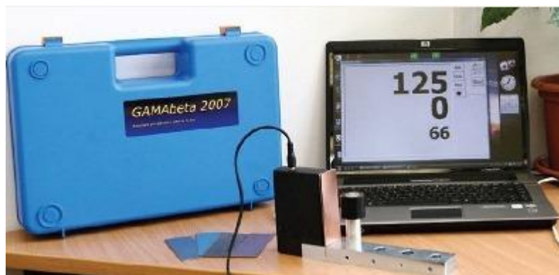
Obr. 4 Souprava GAMAbeta 2007 – zářič a čítač – převzato z [33]
