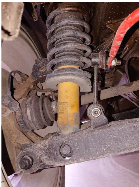
Obrázek 60 – Vyosení tlumiče kvůli prostoru pro hnací hřídel na automobilu Mazda MX-5 NB
