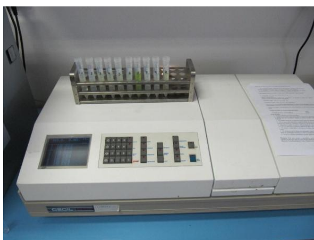
Obrázek 26 Měření absorbance supernatantu na spektrofotometru CECIL (foto J. Konecká)
