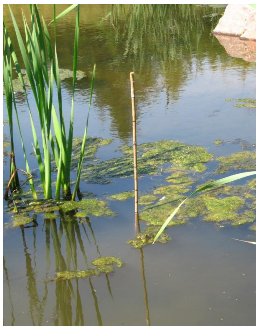
Obrázek 18 Bambusová tyč, sloužící ke sledování kolísání vodní hladiny (foto J. Konecká)
