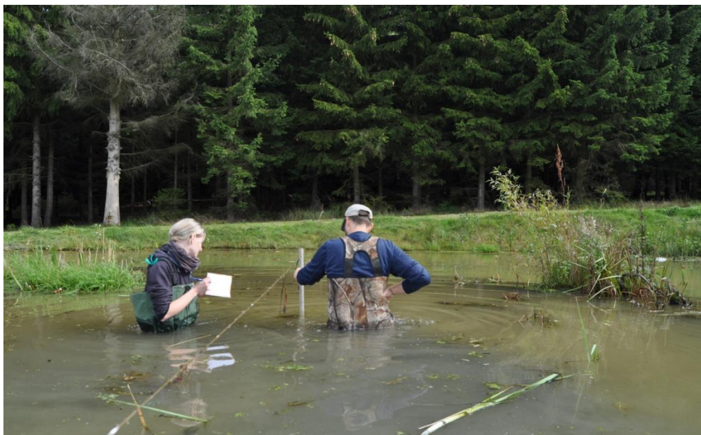
Obrázek 17 Měření hloubek v příčném profilu tůně (foto A. Bednařík)
