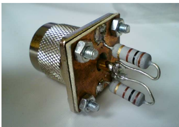
Obr. 3.7: 50\ \Omega umělá zátěž ( P_{\max} = 4\ \text{W} )
