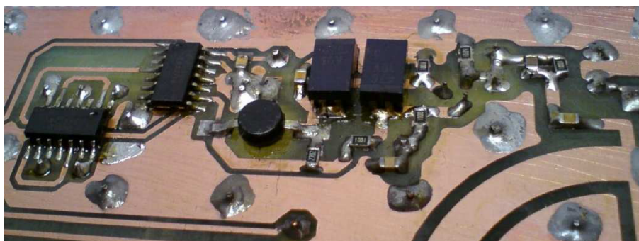
Obr. 3.5: Realizace čítače na desce plošných spojů
