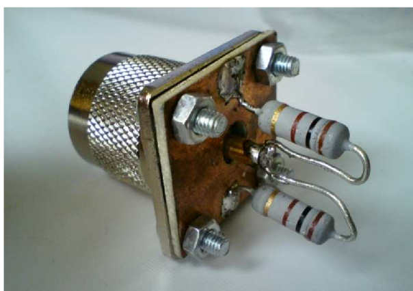
Obr. 3.7: 50 \Omega umělá zátěž ( P_{\max} = 4 \text{ W} )
