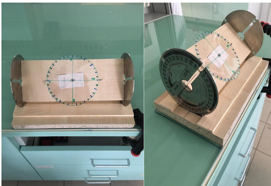
Obr. č. 43 – Úhlový měřič vyfocený zepředu i z boku.
