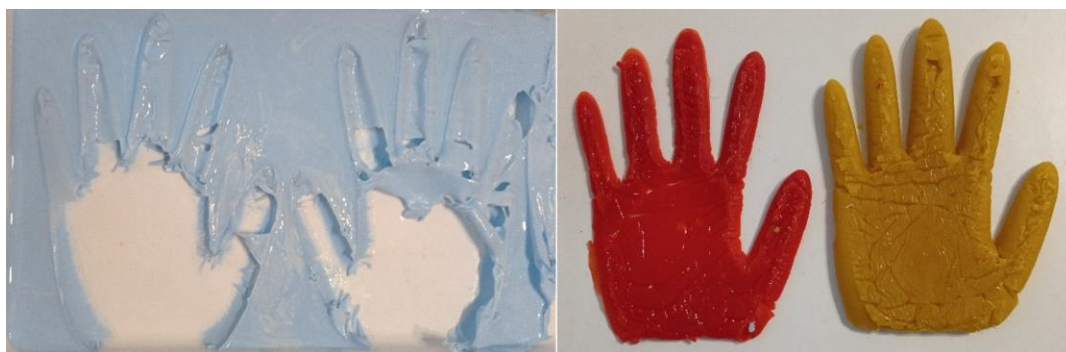
Obr. 34 – Hotová silikonová forma a vytvořené odlitky
