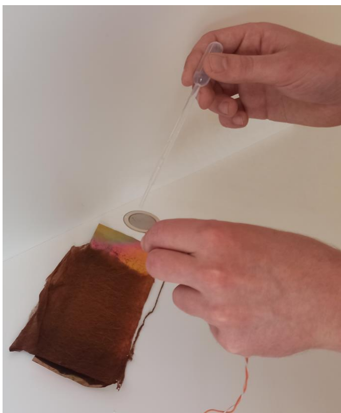
Obrázek 24- Naprašování platinových nanočástic pomocí piezoelektrického měniče
