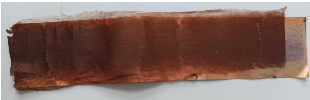
Obrázek 23- Připravená a stabilizovaná ligninová vrstva vláken
