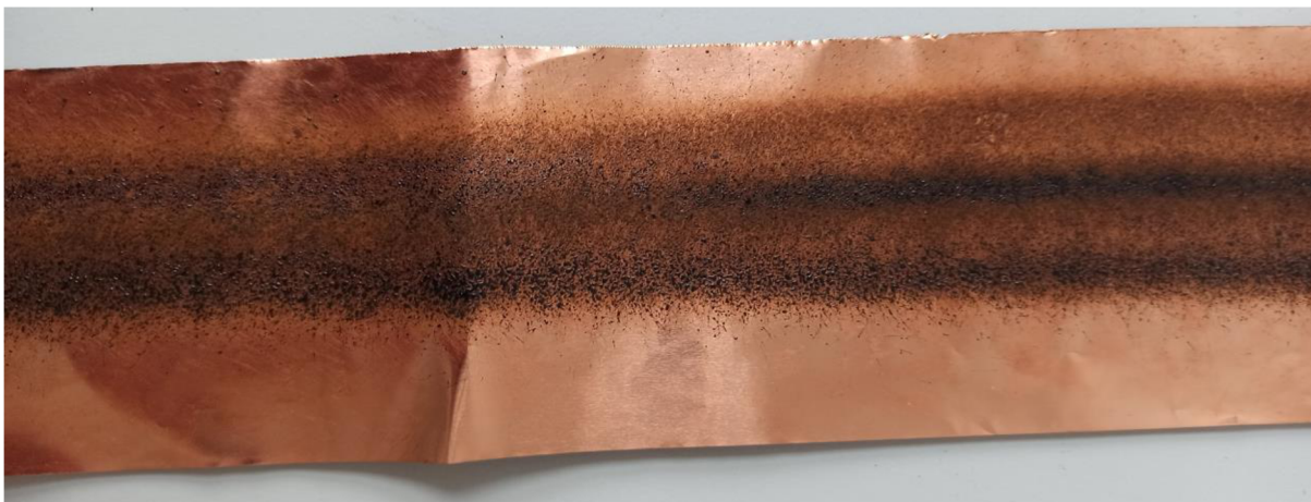
Obrázek 22- Pokus o přípravu vrstvy ligninu s nanočásticemi platiny ve zvlákňovacím roztoku
