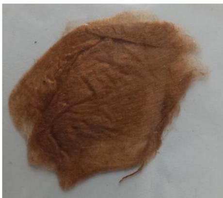
Obrázek 20- Nadýchanější připravená vrstva ligninových vláken
