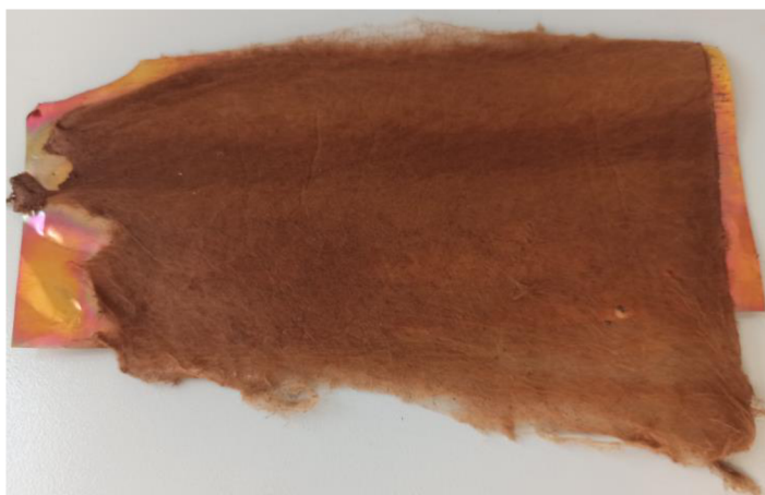
Obrázek 21- Tenčí připravená vrstva ligninových vláken
