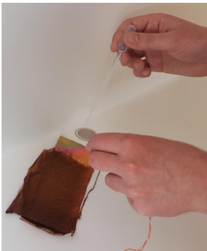
Obrázek 24- Naprašování platinových nanočástic pomocí piezoelektrického měniče
