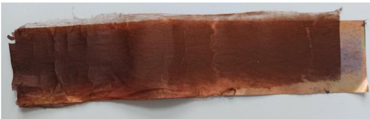
Obrázek 23- Připravená a stabilizovaná ligninová vrstva vláken
