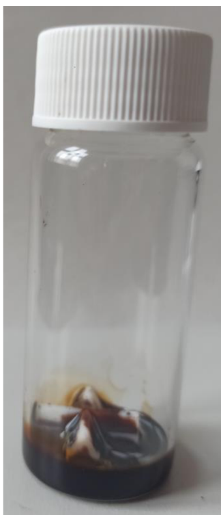
Obrázek 12- Připravený zvlákňovací roztok ligninu bez nanočástic
