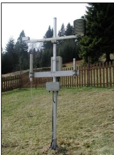
Obr. č. 6 – Měřicí jednotka sítě včasného měření [47]
