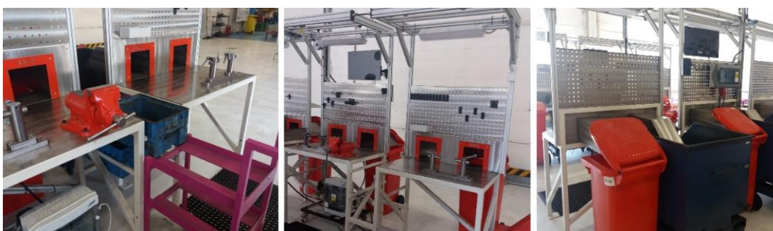
Obrázek E4: Návrh na demontážní stůl zepředu a zezadu Zdroj: vlastní zpracování
