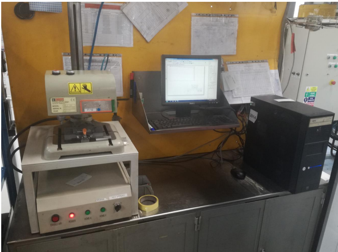
Obrázek F2: Současné zařízení pro vyražení ID štítku na pracovišti olejového testování Zdroj: vlastní zpracování
