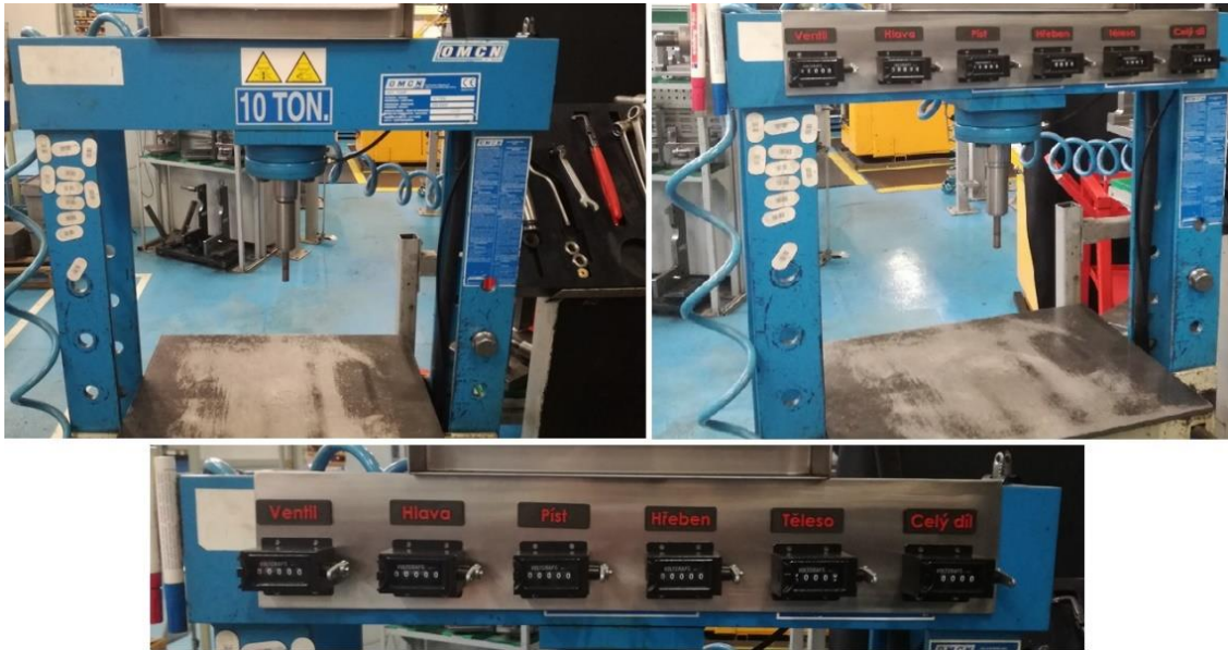
Obrázek F1: Stav před a po návrhu na zlepšení počítání na pracovišti demontáže Zdroj: vlastní zpracování
