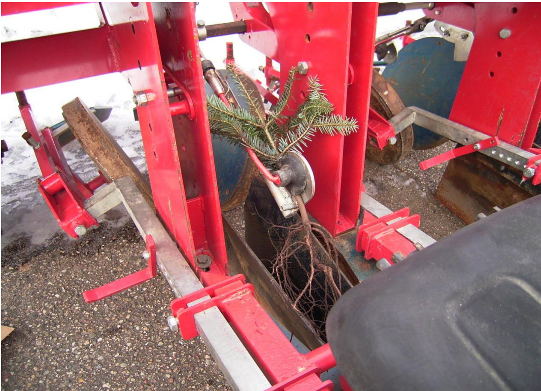
Příloha 2: Sázecí stroj č.2 s přísavkami pro kvalitnější a rychlejší výsadbu Zdroj: vlastní archiv
