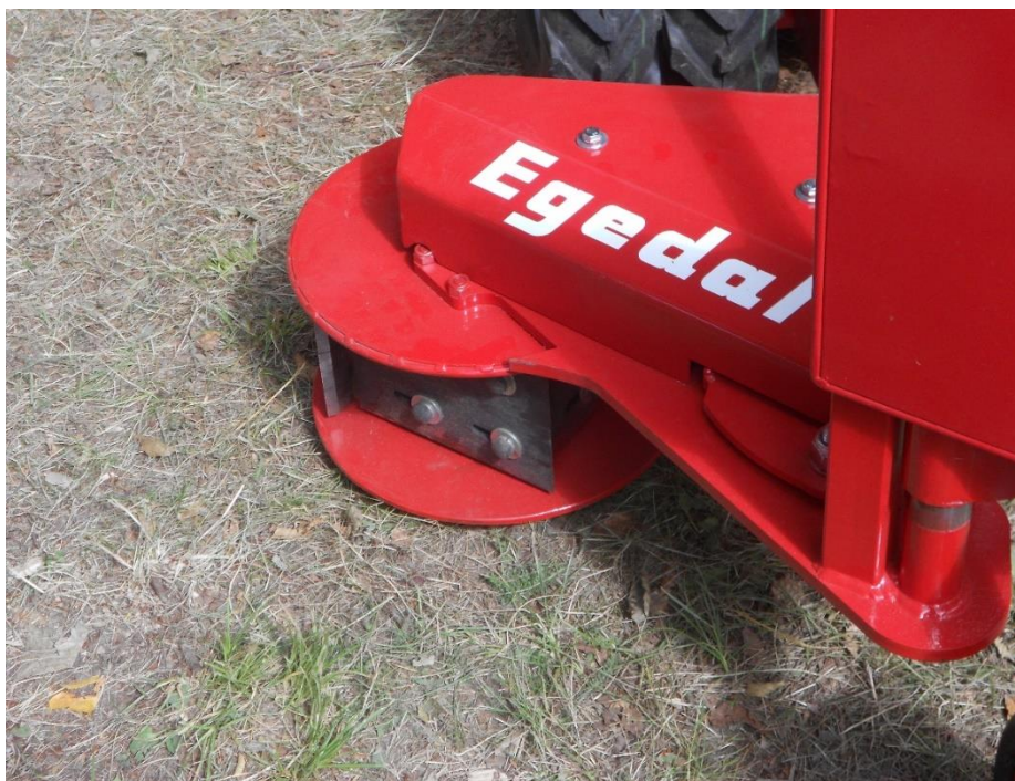
Příloha 14: Fréza k odstranění spodních větví na kmínku Zdroj: vlastní archiv
