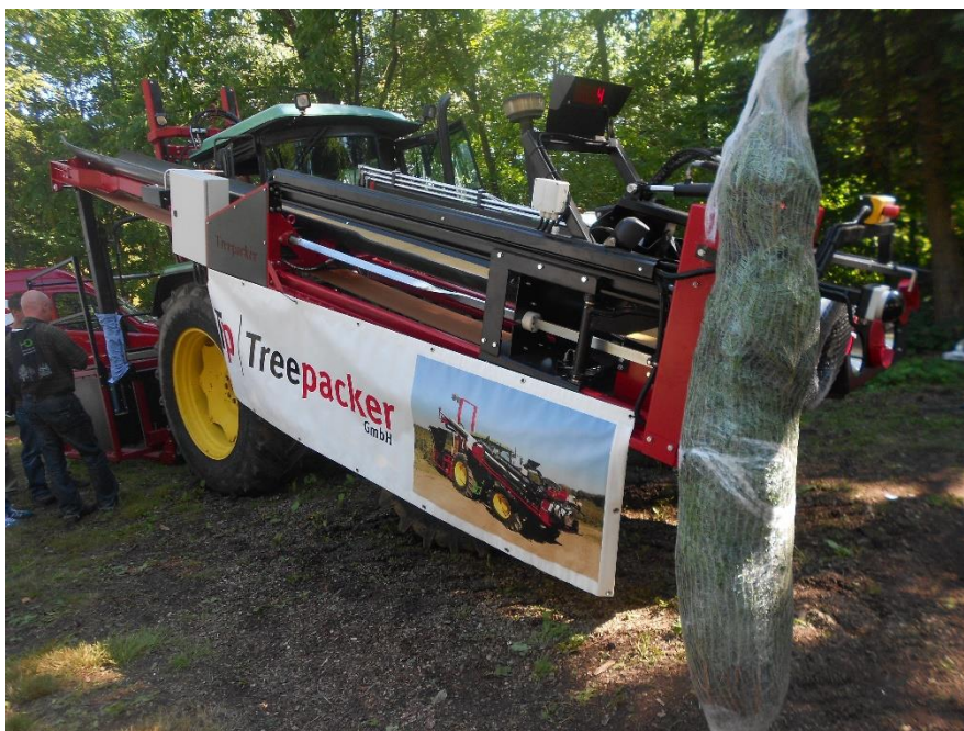
Příloha 16: Balící zařízení na přední straně traktoru, spojené pásovým dopravníkem se zadní částí, kde se nachází paletovací systém Zdroj: vlastní archiv
