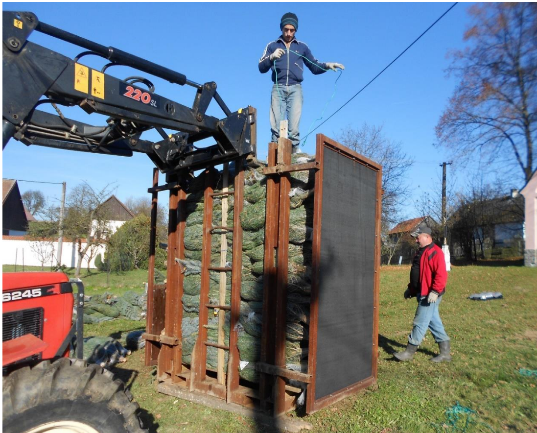
Příloha 18: Jednoduchá paletovací klec ve spolupráci s čelním nakladačem pro přechování a vyzvedávání palet Zdroj: vlastní archiv
