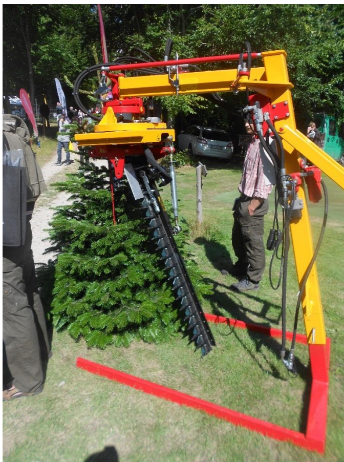
Příloha 15: Tvarovací zařízení pro absolutně pravidelný stříh od firmy Damcon Zdroj: vlastní archiv
