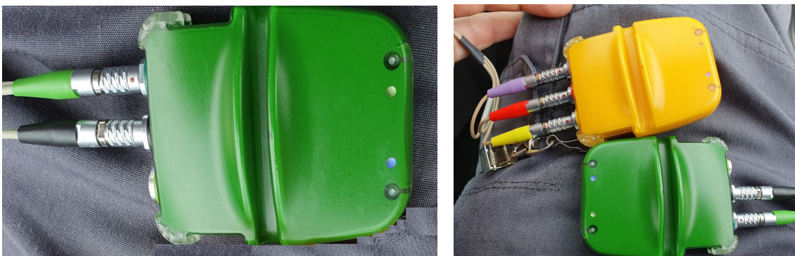
Obrázek č. 23: EMG modul a MULTI modul při měření (modrá dioda značí přenos signálu (autor)
