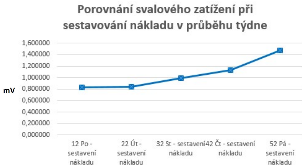
Obrázek č. 61: Průběh změny svalové zátěže při sestavování nákladu během celého pracovního týdne v mV (autor)
