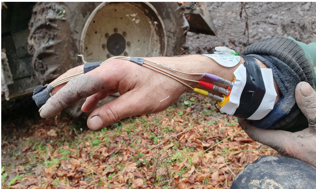
Obrázek č. 29: Upevnění senzoru MULTI modulu na posledním článku prostředního prstu operátora traktoru (autor)
