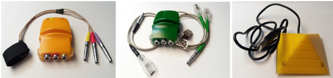
Obrázek č. 21: Vysílací moduly MULTI (žlutý) a EMG (zelený), přijímací modul (pyramida) (autor)
