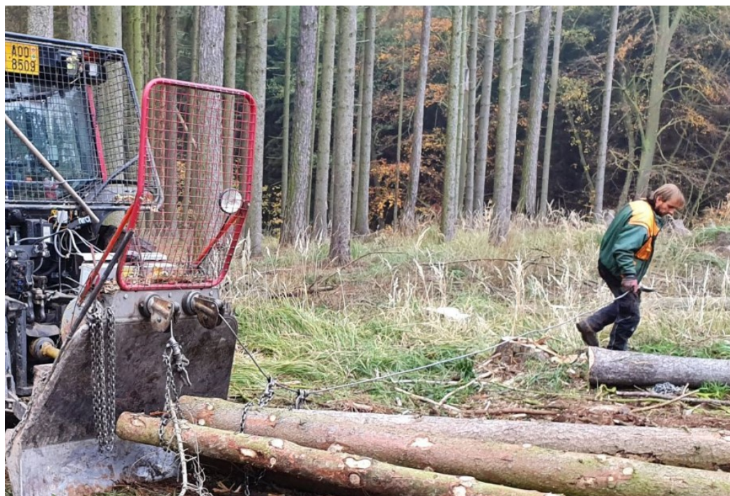
Obrázek č. 11: Pracovní poloha při sestavování nákladu – příprava úvazku (autor)
