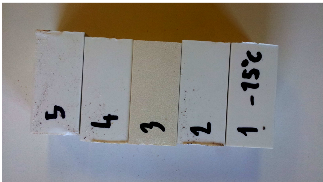
Vzorky po tlakovém zatížení pod úhlem 45^\circ za teploty -15^\circ\text{C}
