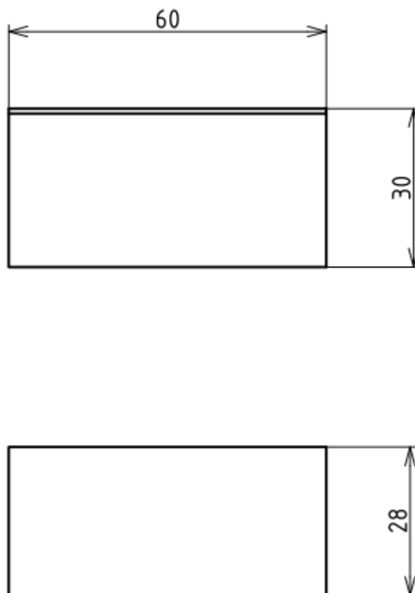
Obr. 16 Rozměry vzorků pro smykové zatížení pod úhlem 45°
