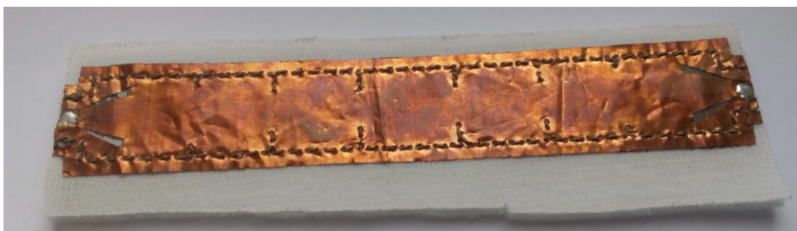
Obrázek 23: Vyrobený filtr s koplanárním buzením s textilním substrátem a měděnou folií
