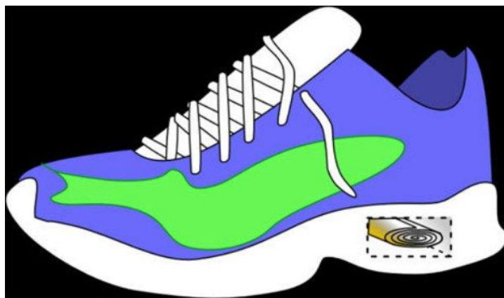
Obrázek 7:Schéma generátoru již vloženého do podrážky [5].
