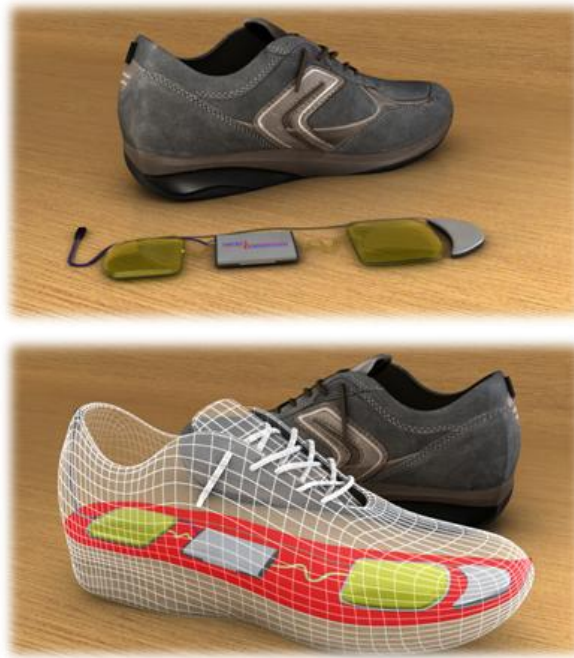
Obrázek 8: Generátor na principu elektrického namáčení [6].
