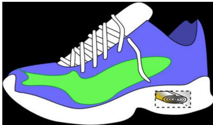
Obrázek 7:Schéma generátoru již vloženého do podrážky [5].
